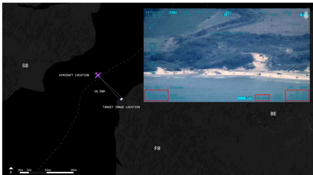
L'image en haut à droite correspond à une image fixe extraite du flux vidéo du capteur optique de Phoenix, avec les positions de l'aéronef et de la cible indiquées dans la partie inférieure. Autour de cette image, ces positions sont superposées à une cartographie de la Manche. Border Forensics, 2026
